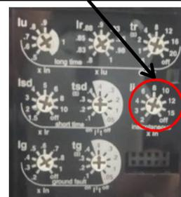
4. При помощи OCR тестера симитируйте подачу на выключатель тока  $16 I_n$
